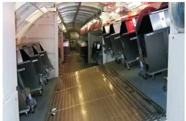
Schiefe Ebene zur Simulation eines verunfallten Flugzeugs
